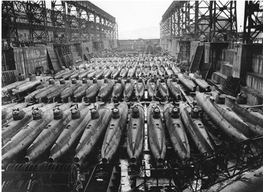
呉海軍基地に放置された特殊潜航艇「蛟龍」（全長26m直径2m）。1945年10月に米海軍が撮影したもの（U.S. National Archives）
